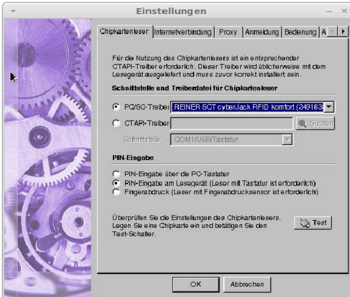
Wenn der Kartenleser ordnungsgemäß installiert ist, kann er im Auswahlménü ausgewählt werden. Alle aktuellen cyber<sup>Jack</sup>-Modelle haben eine eigene Tastatur, daher sollte diese auch aus Sicherheitsgründen zur Eingabe der PIN verwendet werden.
