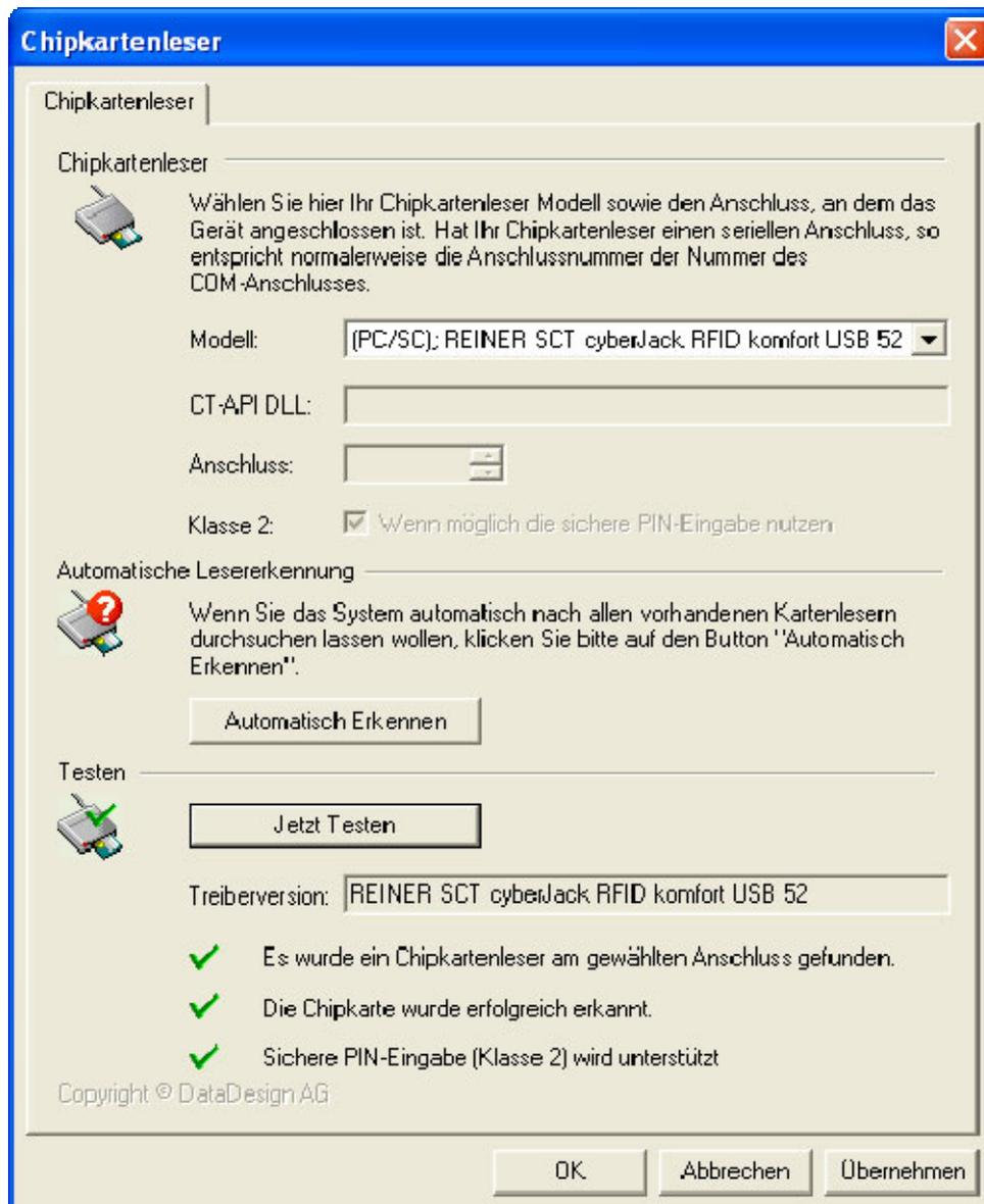
Wird der Leser über PC/SC angesprochen, sieht die Konfiguration wie oben aus.
